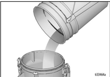
4. Desmonte la boquilla de la pistola. Dispare la pistola hacia el interior de un cubo hasta que haya bombeado la mayor parte de la mezcla de textura al exterior de la tolva. Permita que el agua fluya a través de la pistola hasta que la pistola esté limpia.
