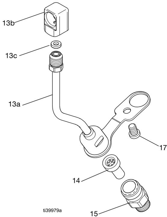
FIG. 57: Conjunto del tubo de fluido: modelo 26B711
